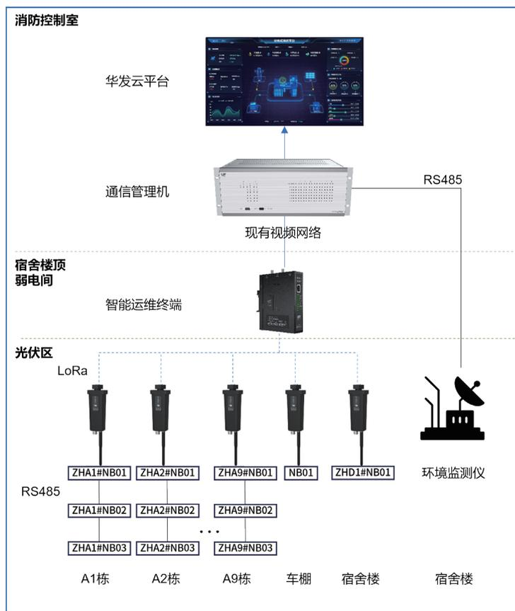
基于LoRa组网, 无需铺设通信线缆
